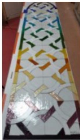
Phase de la coupe des verres terminée pour les deux baies
